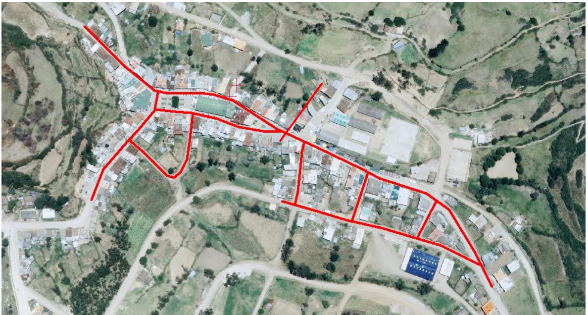
Ilustración 27: Vías con pavimento rígido en la cabecera cantonal.
